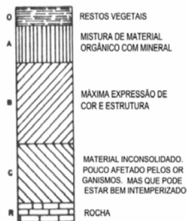
ESQUEMA DE UM PERFIL DE SOLO HIPOTÉTICO MOSTRANDO OS PRINCIPAIS HORIZONTES (LEPSCH, 1976)
