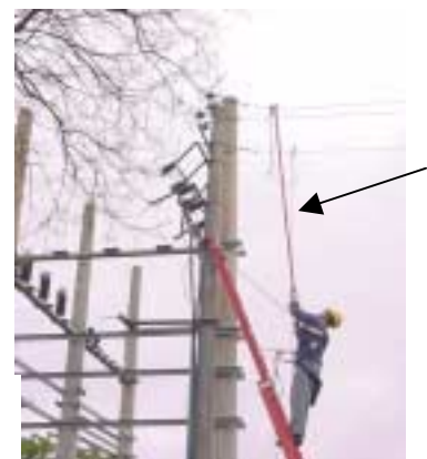
Teste de isolamento em vara de manobra
