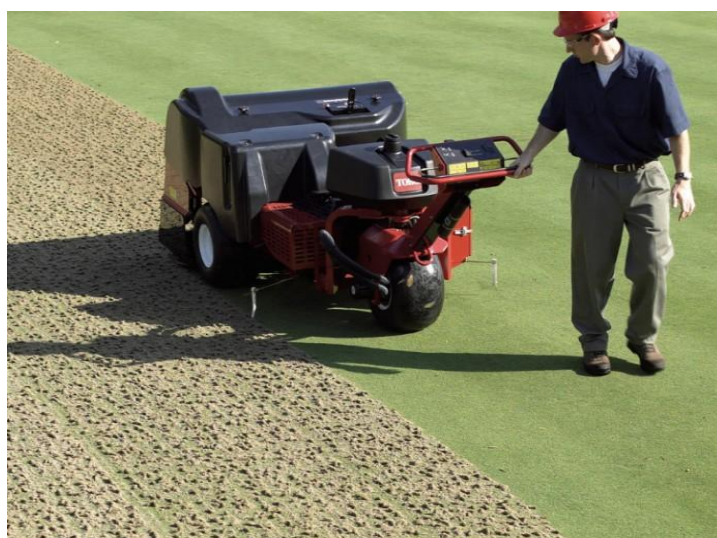
Ilustração 23 – Aerificação de um fairway
