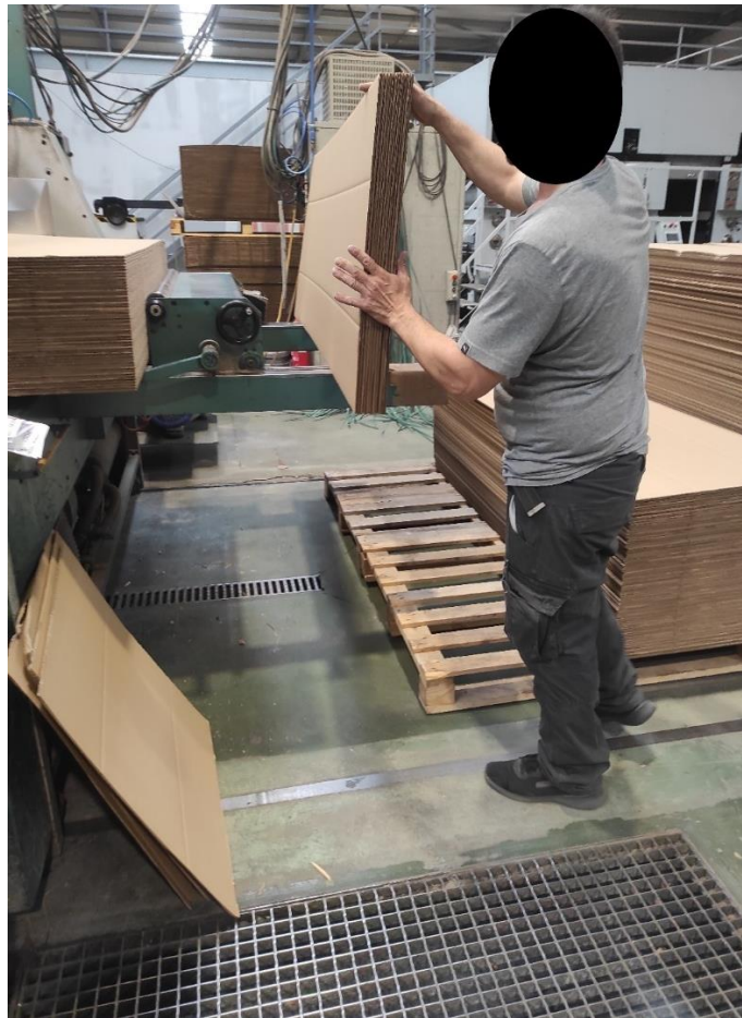
Figura 4: Colocação de molde de cartão na máquina
