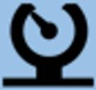
**Pressão** – Tubagem de pressurização, garrafas de gases comprimidos, tubagens de controlo, recipientes sob pressão, reservatórios, mangueiras e equipamento pneumático e hidráulico
