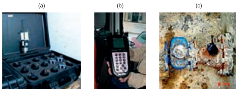
Figura 9.10 – Sensores acústicos de detecção de fugas: (a) sensores; (b) patrulhador; (c) instalação de sensor num acessório
