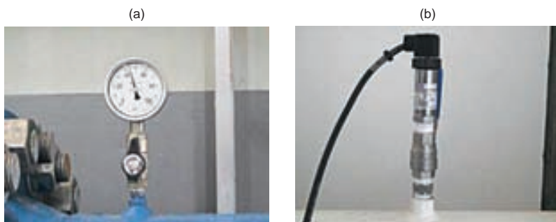
Figura 9.18 – Medidores de pressão: (a) manómetro e (b) transdutor
