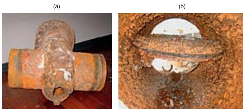
Figura 2.7 – Válvulas degradadas por efeito de corrosão: (a) válvula perfurada por corrosão e (b) válvula inoperacional por corrosão
