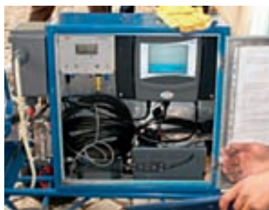
Figura 9.22 – Equipamento para a realização do teste RPM
