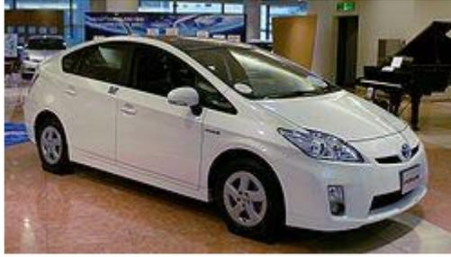
Um automóvel híbrido é um automóvel que possui um motor de combustão interna, normalmente a gasolina e um motor elétrico que permite reduzir o esforço do motor de combustão e assim reduzir os consumos e emissões.
