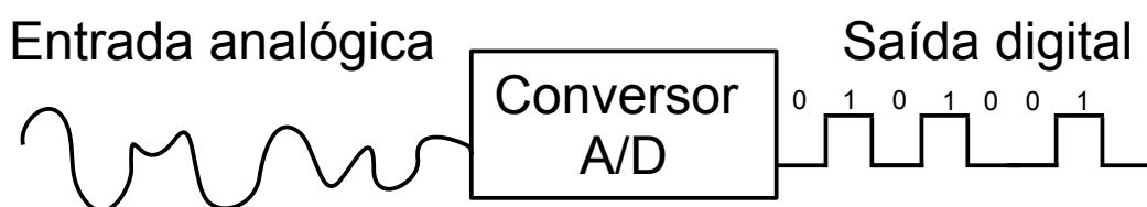
Ilustração 26: Conversão do sinal analógico para digital por um Modem
