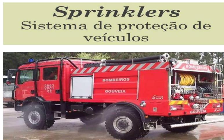
*Figura .5 -Viatura dos bombeiros de Gouveia com sistema proteção de sprinklers*
