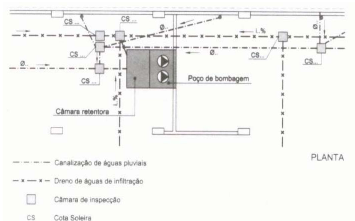
Fig. 27 – Planta da cave com câmara retentora e poço de bombagem (areias e gorduras)
