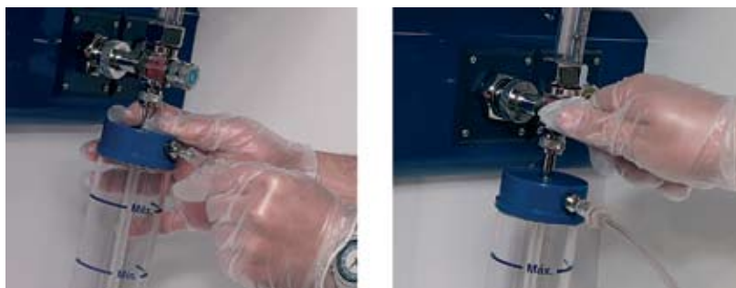
Fig. 40 Montagem do debitómetro numa rampa de oxigénio.
