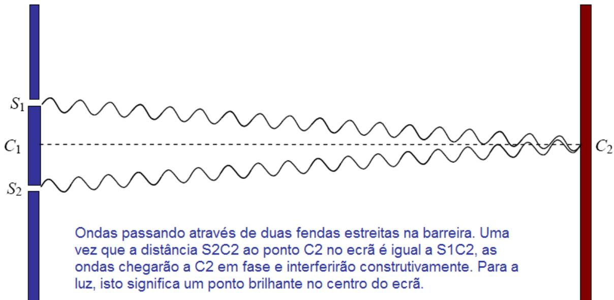
Para ondas de luz passando através de duas fendas estreitas e incidindo num ecrã (do lado direito) haverá um outro ponto brilhante num ponto  $P$  longe do centro  $C_2$  do ecrã, desde que as distâncias de  $P$  a ambas as fendas difiram por um número inteiro de comprimentos de onda:
