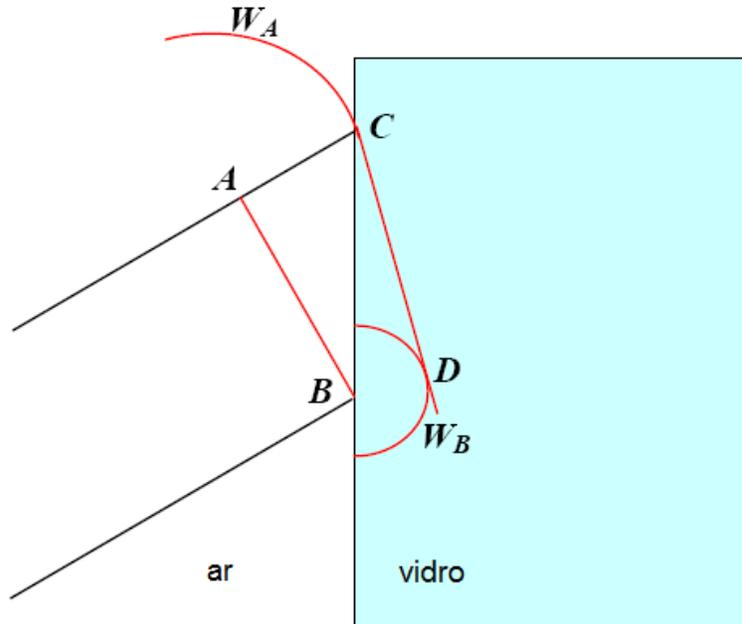
**Explicação de Huygens da refração:** duas ondas secundárias da frente de onda  $AB$ ;  $W_B$  é mais lenta que  $W_A$ , porque se está a propagar no vidro. Isto faz com que a onda mude de ângulo.
