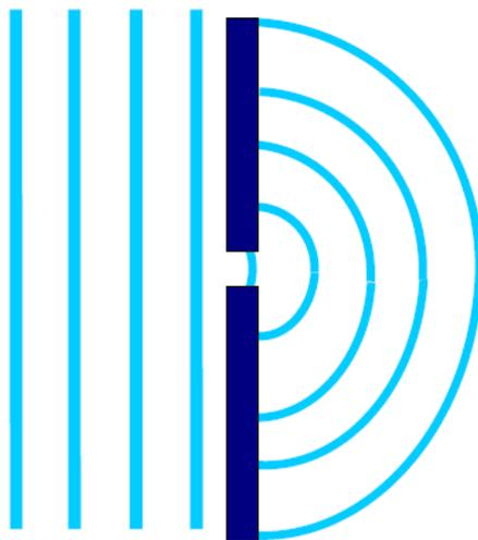
Uma onda plana encontra uma barreira com uma abertura mais pequena que o comprimento de onda: a onda espalha-se circularmente do outro lado.
