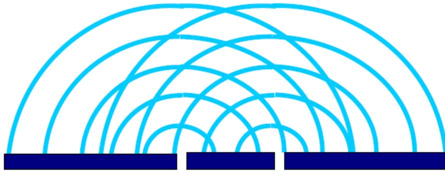
Ondas espalhando-se a partir de duas pequenas fendas na barreira: os círculos azuis representam cristas de onda, onde duas se cruzam a onda tem um valor máximo positivo, por exemplo ao longo da linha central.
