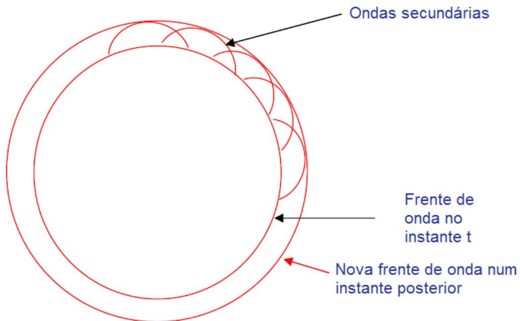
Modelo de Huygens para a propagação de onda esférica: cada ponto da frente de onda é uma fonte secundária de ondas cuja interferência resulta na frente de onda do instante seguinte.
