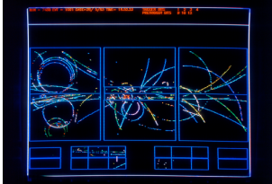
Figura 3.2: Exemplo de um evento registado no CERN. As trajectórias das partículas são reconstruídas por computadores a partir de sinais electrónicos nos detectores[1].
