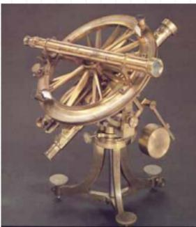
O teodolito é um instrumento óptico de medição de posições relativas. É vulgarmente utilizado em topografia, navegação e em meteorologia; mede distâncias relativas entre pontos determinados, em escala métrica decimal (múltiplos e sub-múltiplos).
