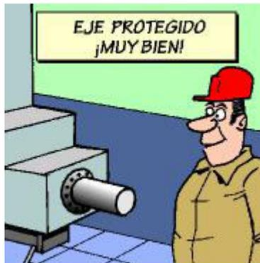
Ni qué decir tiene que el resto de los ejes, árboles de potencia y sus acoplamientos, y cualquier otro elemento de máquina, móvil y/o giratorio, que no sean lisos, deben estar convenientemente protegidos con cubiertas.
