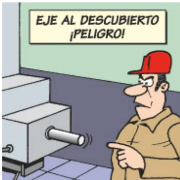
Se recomienda proteger los ejes, árboles y otros elementos lisos giratorios, cubriéndolos completamente con protecciones, cubiertas o carcasas adecuadas, si se encuentran a alturas inferiores a tres metros sobre el piso o plataforma de trabajo. Se recomienda asimismo cubrir los ejes y árboles inclinados o verticales, hasta la altura citada.
