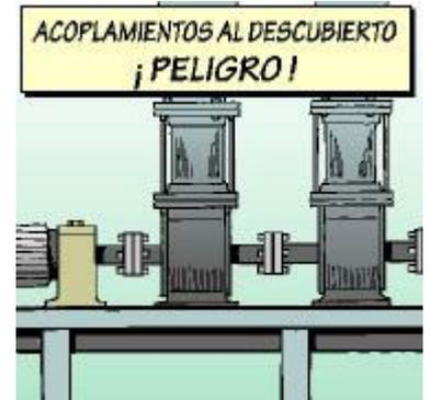
Las protecciones de los elementos móviles no deben ser retiradas bajo ningún concepto. Sólo el personal debidamente autorizado, para realizar reparaciones o ajustes, podrá retirar las protecciones con la máquina parada, y deberá reponerlas en su posición de trabajo tan pronto como sea posible.
