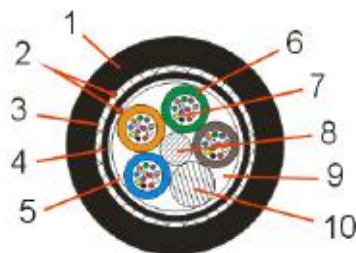
3.22 - Exemplo de cabo multifibras
