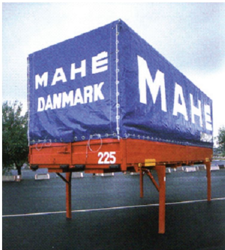
Figura 14: Caixa móvel assente sobre pés de fixação (patolas)
