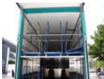
Figura 62: Palete com rodas com suportes laterais e barras para grampos
