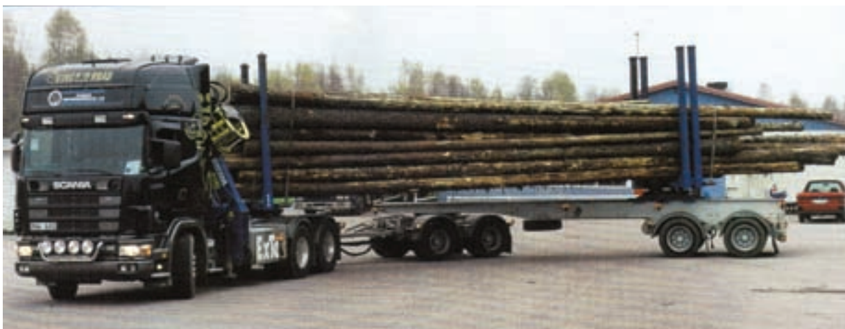
Figura 80: Transporte de troncos inteiros (Veículo para fins especiais não conforme com a Directiva 96/53/CE)
