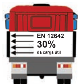
Figura 6: Requisitos de resistência dos painéis laterais
