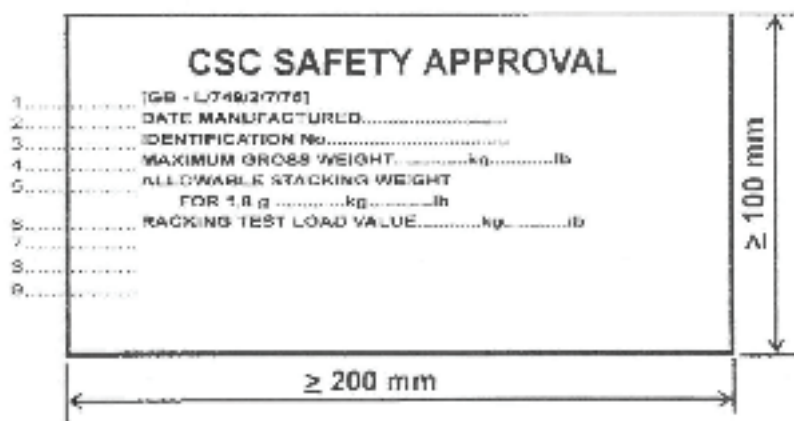
Figura 8.10.7.4 Placa com homologação de segurança dos contentores
