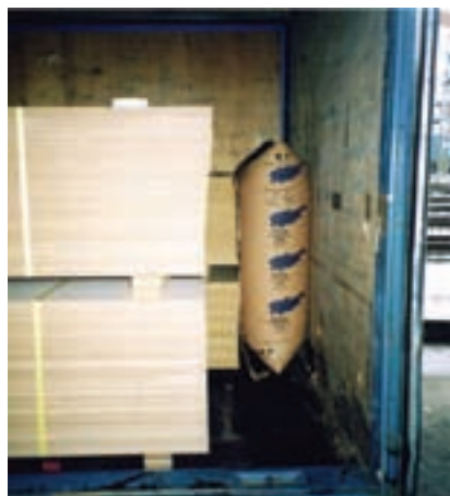
Figura 17: Almofadas de ar num semi-reboque
