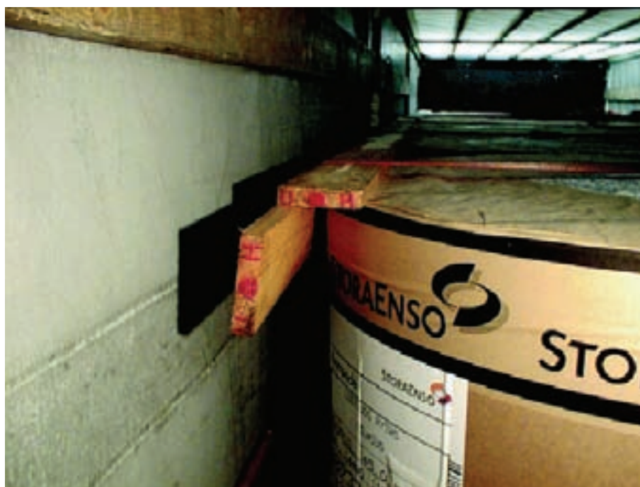
Figura 51: Viga de bordadura feita de tábuas de madeira
