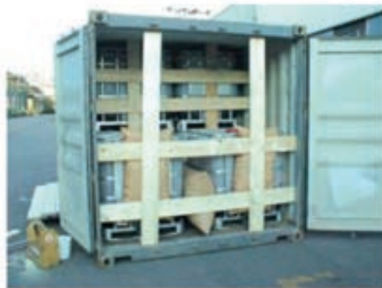
Figura 88: Grandes recipientes para granel (GRG) em pilha dupla num contêiner
