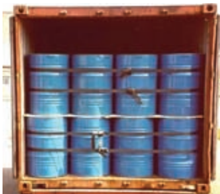
Figura 87: Tambores soltos em pilha dupla num contentor, duas camadas de quatro filas
