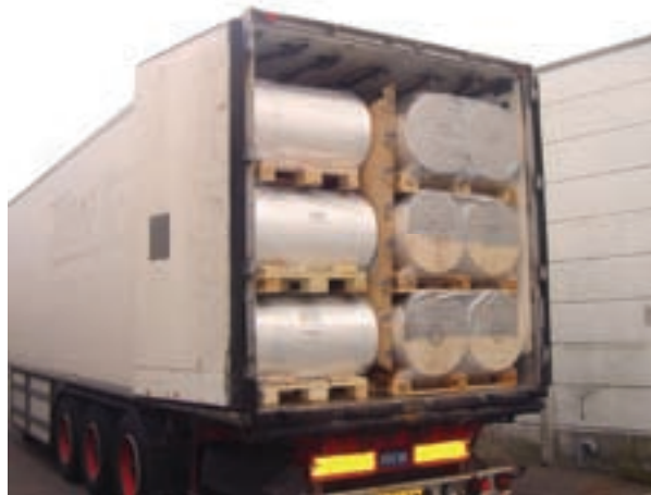
Figura 16: Material de enchimento entre as camadas de carga
