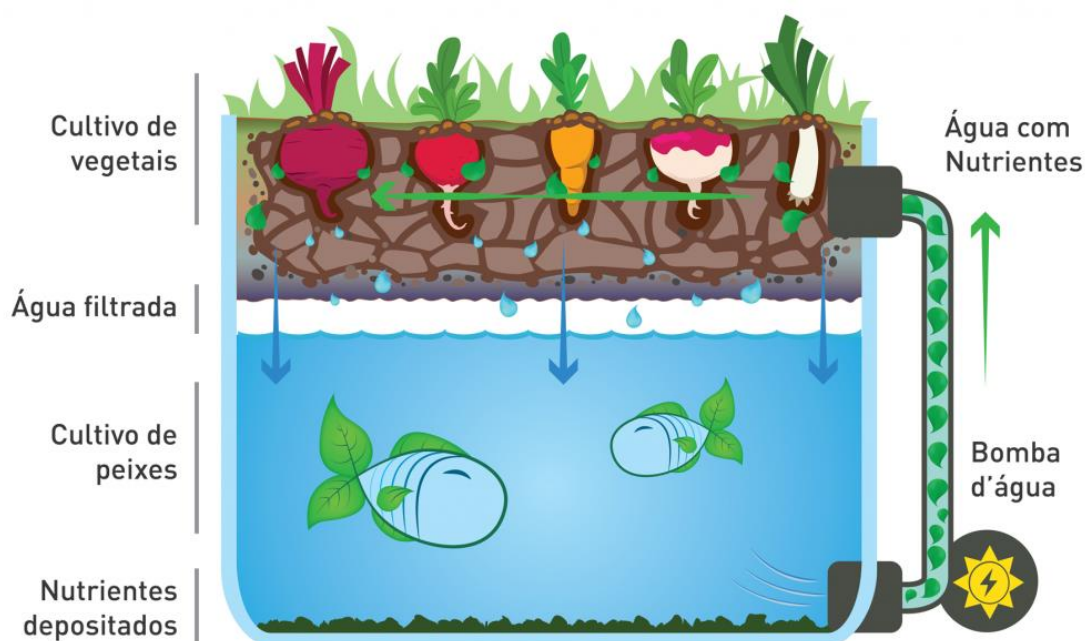
Figura 174 Esquemática de um sistema de aquaponia - http://aqpbrasil.com/home/aquaponia/
