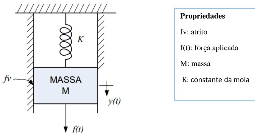
Figura 1. Esquema do sistema massa mola
