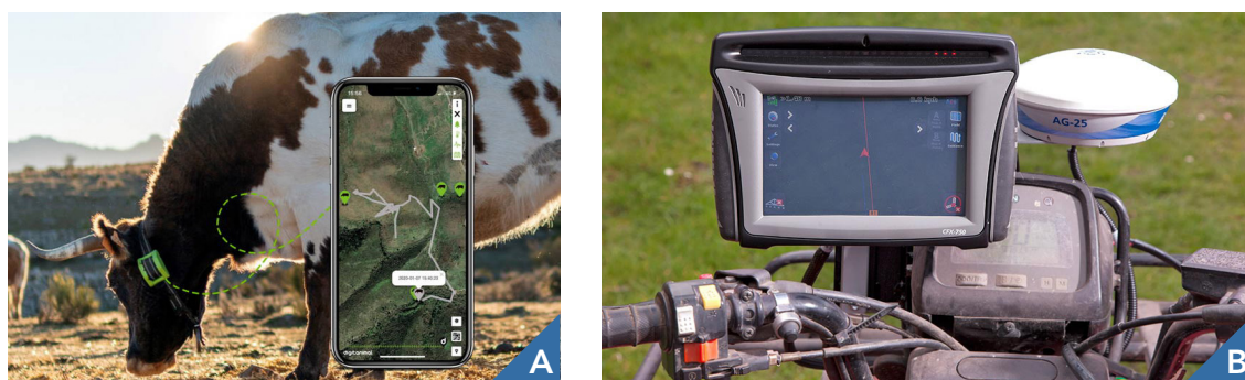
Figura 2 - a) Colar de GNSS para georreferenciação de animais - b) Sensor montado em moto quatro para auxílio à condução | Fonte: a) Digitanimal, s.d - b) Trimble, 2021a
