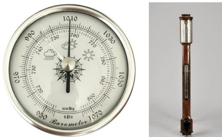
Figura 31 - Barômetro aneróide (à esquerda) (Anónimo b s.d) e de mercúrio (à direita) Fonte: Anónimo c s.d
