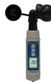
Figura 33 - Anemômetro – Aparelho que registra a velocidade do vento | Fonte: Anônimo, 2021a
