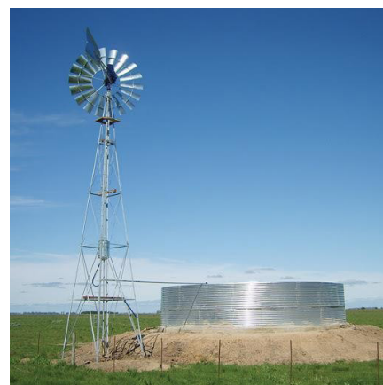
Figura 8 - Aplicação prática de energia eólica para bombeamento de água | Fonte: http://famaconsa.com/molinos/huracan-3/?lang=pt
