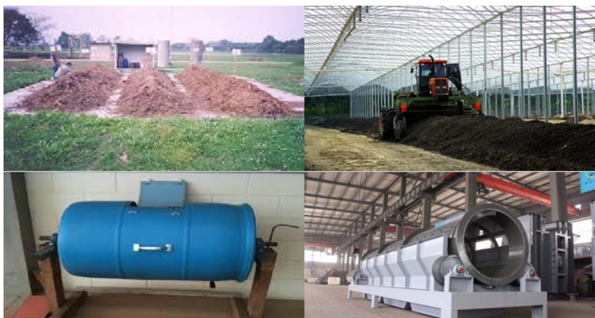
Figura 21 - Contentores arejados e Contentores rotativos e arejados, à esquerda e direita respetivamente em cima; Silos de compostagem e Tambores rotativos, à esquerda e direita respetivamente em baixo | Fonte: RuralSmart; https://biofactor.pt/compostagem-industrial/
