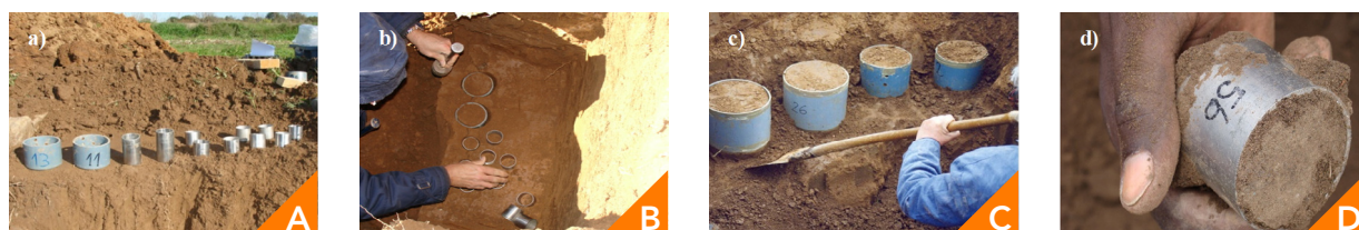
Figura 4 - Colheita de amostras no estado natural. Os cilindros metálicos ou de pvc são enterrados lentamente de modo a perturbar o mínimo possível a estrutura do solo. No caso dos cilindros maiores, é, geralmente necessário retirar o solo envolvente para que seja possível enterrar o cilindro com a menor compactação. (a) Exemplo de cilindros usados na colheita de amostras no estado natural; (b) cilindros enterrados num horizonte/camada de solo; (c) processo de colheita das amostras de maior dimensão; e (d) amostra não perturbada | Fonte: Ramos et al., 2016
