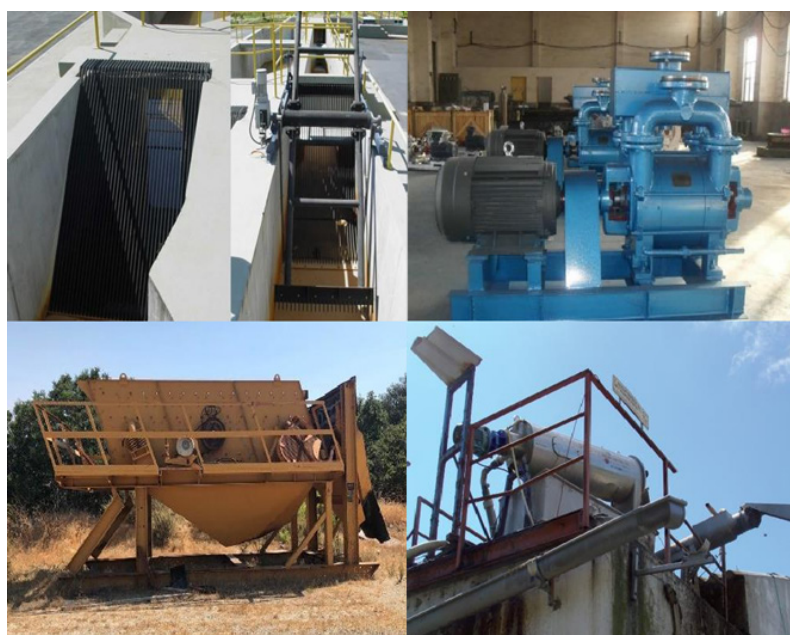
Figura 30 - Tecnologias para separação de sólidos: grades de retenção de detritos e centrífuga, à esquerda e direita respetivamente em cima; tamisador e prensa, à esquerda e direita respetivamente em baixo | Fonte: Brendal et al., 2015
