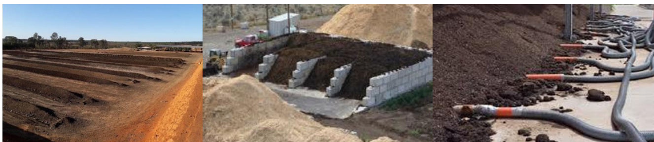
Figura 19 - Pilhas longas reviráveis, pilhas estáticas e pilhas estáticas com arejamento forçado, da esquerda para a direita respetivamente Fonte: https://www2.arb.ca.gov/sites/default/files/classic/cc/dairy/documents/12-08-17/dsg1_csuchico_presentation_120817.pdf
