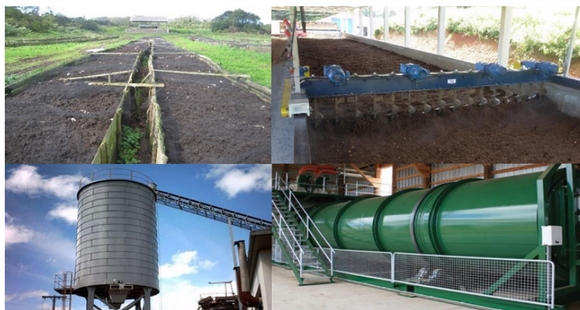
Figura 20 - Contentores arejados e Contentores rotativos e arejados, à esquerda e direita respetivamente em cima; Silos de compostagem e Tambores rotativos, à esquerda e direita respetivamente em baixo | Fonte: RuralSmart; https://biofactor.pt/compostagem-industrial/
