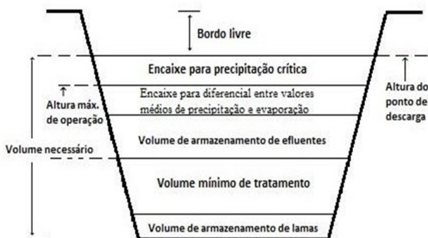
Figura 29 - Corte de uma lagoa anaeróbia | Fonte: Adaptado de USDA-NRCS, 1992
