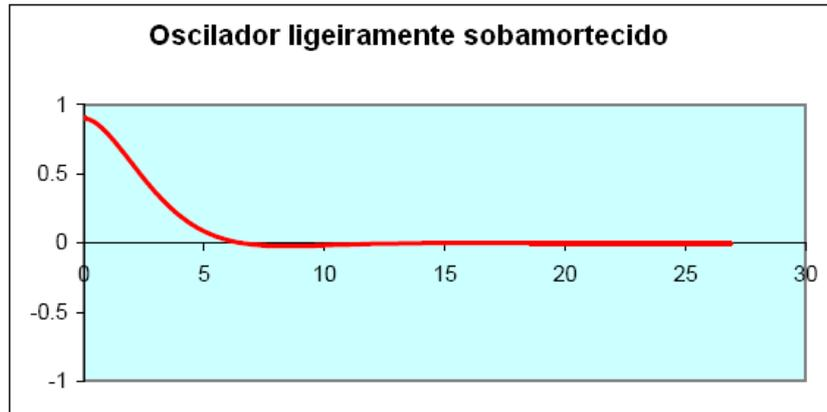
Pode descobrir como é que os absorvedores de choque se comportam exercendo pressão num dos cantos do carro e largando. Se o carro se balanceia claramente, o amortecimento é demasiado pequeno e necessita de novos absorvedores.
