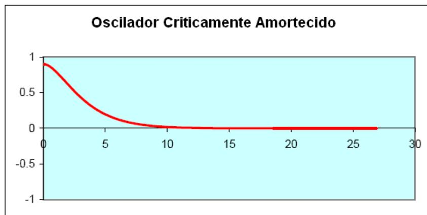
Isto corresponde a  $\omega' = 0$  na equação para  $x(t)$  acima, por isso é uma curva puramente exponencial. De notar que o oscilador se move mais rapidamente para zero do que no caso de sobreamortecimento (óleo mais viscoso).
