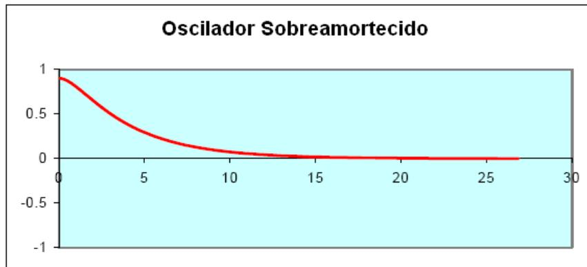
A linha divisora entre sobreamortecimento e sobamortecimento é chamada **amortecimento crítico**. Mantendo tudo constante excepto a força de amortecimento, o amortecimento crítico é tal que:
