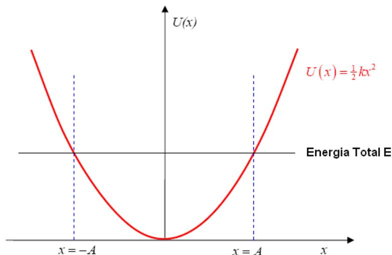
**Energia Potencial  $U(x)$**  para um **oscilador harmônico simples**. Para energia **total**  $E$ , o oscilador oscila entre  $x = -A$  e  $x = +A$ .
