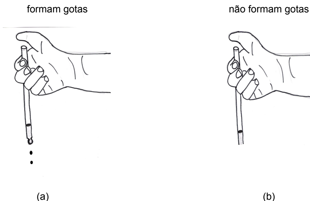
Figura 1.5 – Técnica utilizada para formar gotas: 1) mergulhar a palhinha no material; 2) tapar o topo da palhinha com o dedo polegar; 3) segurar e elevar a mão com a palhinha; 4) destapar (retirar o polegar do topo da palhinha) a palhinha e observar se irá formar gotas (a) ou não (b).
