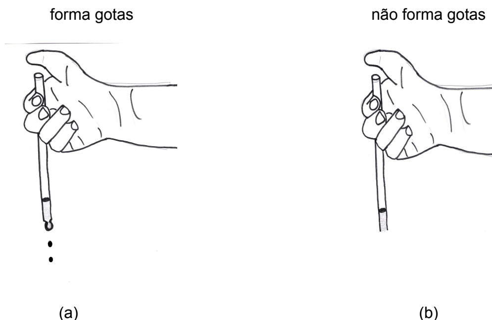
Figura 1.4 – Técnica utilizada para formar gotas: 1) mergulhar a palhinha no material; 2) tapar o topo da palhinha com o dedo polegar; 3) segurar e elevar a mão com a palhinha; 4) destapar (retirar o polegar do topo da palhinha) a palhinha e observar se irá formar gotas (a) ou não (b).
