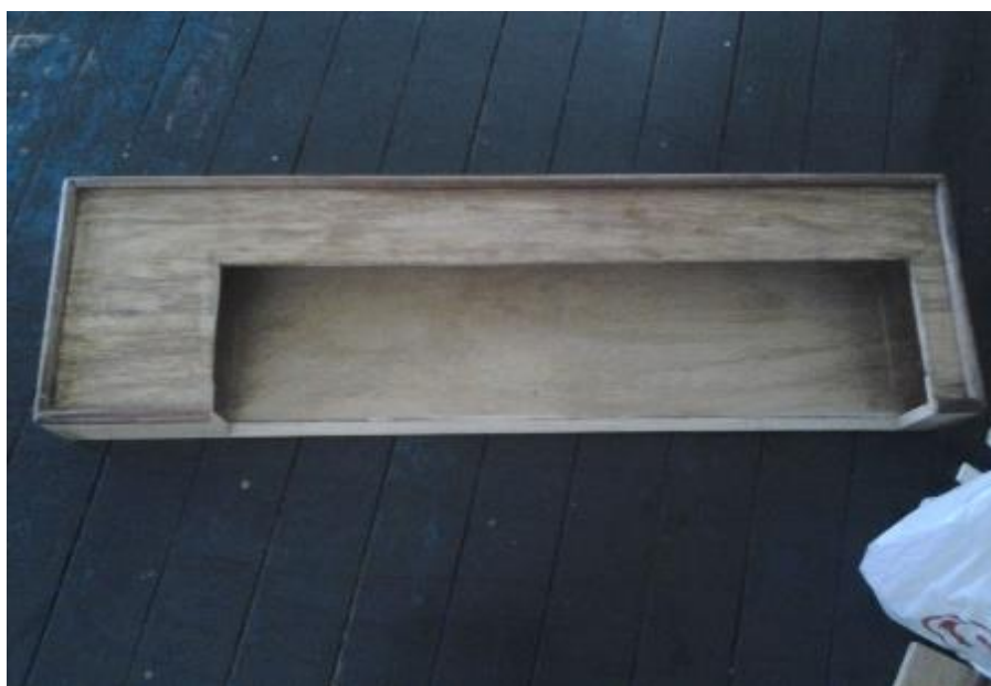
Figura 2 - Estrutura de madeira do teclado.
