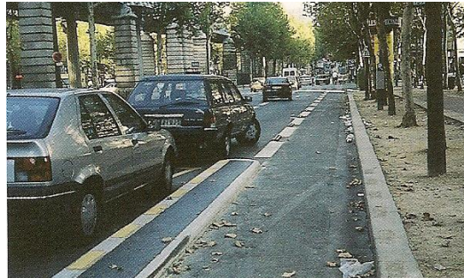
Figure 16 – Intersecção sem semáforos a ciclo via fisicamente separada torna-se numa pista de rodagem antes da intersecção e o estacionamento de superfície não é permitido 20m antes da intersecção (Fonte: Recommendations pour les aménagements cyclables, CERTU, 2008)
