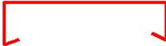
Sua instalação se faz mediante o emprego de pressão, ficando "encaixado" na parte de cima da parede ou mureta. Não é recomendável o emprego de pregos ou parafusos para a fixação do rufo pingadeira, mesmo porque o furo será um ponto fraco, com tendência a enferrujar com mais facilidade. Além disso, ao furar, a chapa vai ficar levemente encurvada para baixo, favorecendo o empoçamento de água da chuva.
